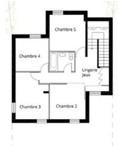
Plan R+1, maison "carrée" Résidence les Vallées, 6 pièces, Bouffémont, dessin de l'auteur Source : Martine et Philippe Deslandes, architectes, Recherche et architecture n°13, 1973, pp23-39
